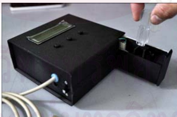
รูปที่ 3.7 ภาพภายนอกของเครื่องวัดทางแสง และช่องสำหรับใส่ตัวอย่าง
