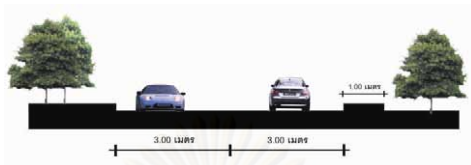
ภาพที่ 4.2 แสดงรูปตัดถนนสายรองโรงไฟฟ้าพระนครใต้
