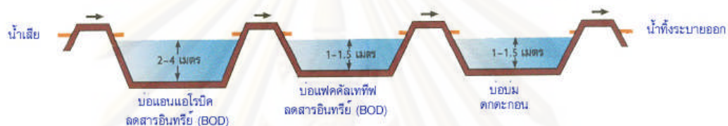
ภาพที่ 2.8 ระบบบำบัดน้ำเสียแบบบ่อปรับเสถียร ( www.sri.cmu.ac.th,6 August 2009)
