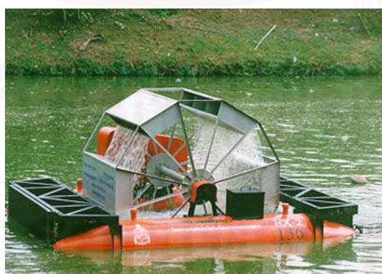
ภาพที่ 2.9 เครื่องเติมอากาศ (Aerator) แบบทุ่นลอย ( www.sri.cmu.ac.th,6 August 2009)
