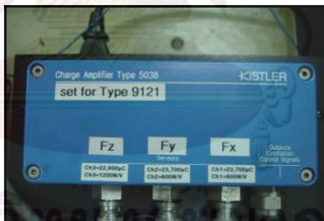
รูปที่ 3.8 ชาร์จแอมป์ไฟเออร์ (Charge Amplifier)
