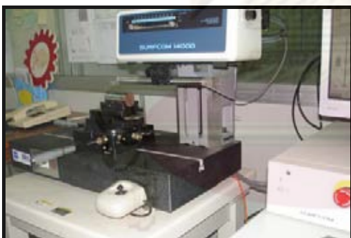
รูปที่ 3.10 เครื่องวัดความเรียบผิว (Roughness Tester)
