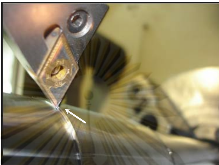
รูปที่ 3.15 แสดงตำแหน่งจุดที่วัดอุณหภูมิ
