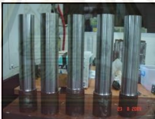
รูปที่ 3.2 แสดงเหล็กที่ใช้ในการวัดความหยาบผิว
