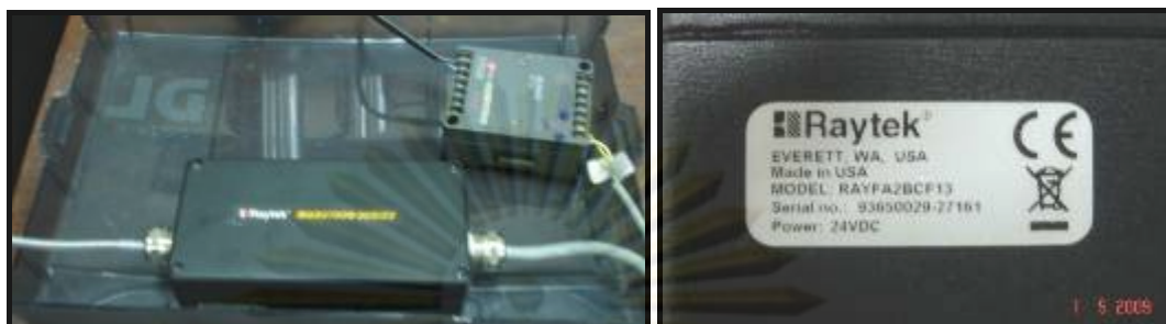
รูปที่ 3.5 แสดงเครื่องวัดอุณหภูมิแบบไม่สัมผัส (Pyrometer)
