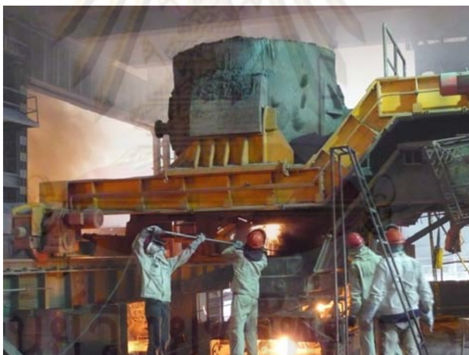
รูปที่ 2-11 เบ้ารับน้ำเหล็กขณะทำการถ่ายน้ำเหล็กไปยังอ่างรับน้ำเหล็ก
