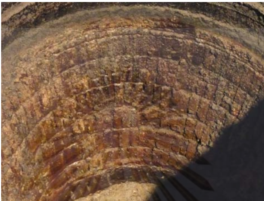
รูปที่ 2-14 เบ้ารับน้ำเหล็กที่ผ่านการใช้งานมา 46 รอบ
