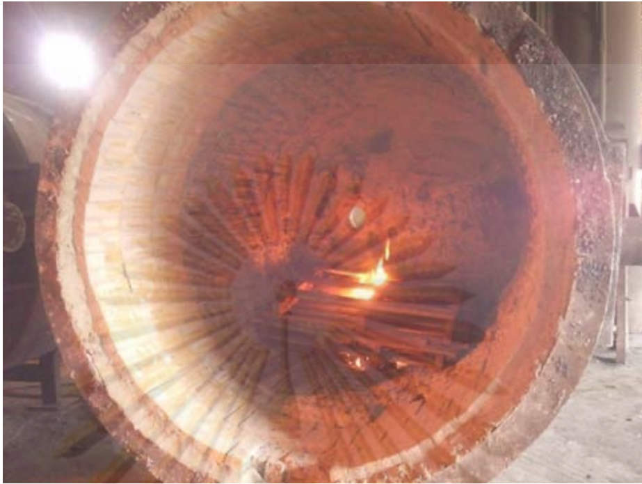
รูปที่ 2-8 การอุ่นเบ้ารับน้ำเหล็กเพื่อไล่ความชื้น โดยใช้เศษไม้เป็นเชื้อเพลิง
