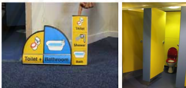
ภาพที่ 2.5 แสดงใช้สัญลักษณ์ และสีที่ตัดกันในห้องน้ำ
