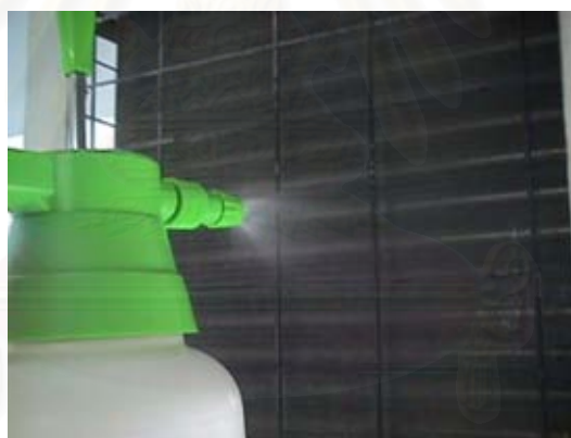
รูปที่ 4.17 แสดงการพ่นละอองน้ำไปผสมกับอากาศก่อนเข้าไปแลกเปลี่ยนความร้อนกับแผงคอยล์ร้อน (Condenser) ที่ใช้ในการทดสอบ
