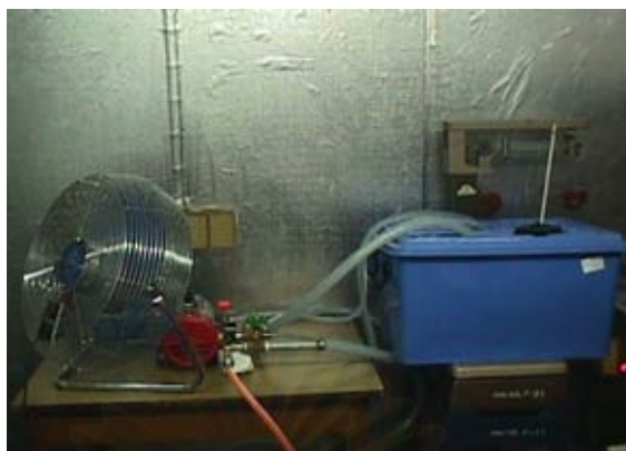
รูปที่ 4.32 แสดงระบบพ่นน้ำและถังน้ำ
