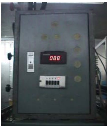
รูปที่ 4.9 อุปกรณ์วัดอุณหภูมิสารทำความเย็น
