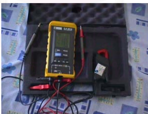
รูปที่ 4.7 มิเตอร์วัดกำลังไฟฟ้าแบบเคลื่อนที่วัด
