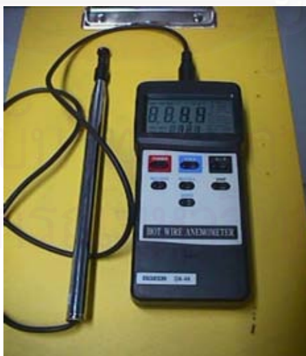
รูปที่ 4.12 อุปกรณ์วัดความเร็วลม
