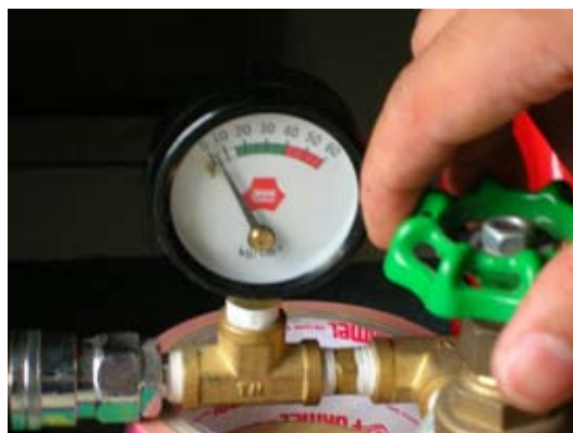
รูปที่ 4.23 แสดงการปรับวาล์วเพื่อปรับระดับแรงดันของน้ำที่ 5 Bar
