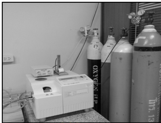
รูปที่ 3.11 เครื่องเทอร์โมกราวิเมตริกแอนนาไลเซอร์ (thermal gravimetric analyzer, METTLER TOLEDO รุ่น TGA/SDTA 851°)
