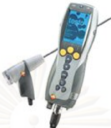
รูปที่ 3.16 เครื่องวัดก๊าซไอเสียและค่าประสิทธิภาพการเผาไหม้แบบพกพา
