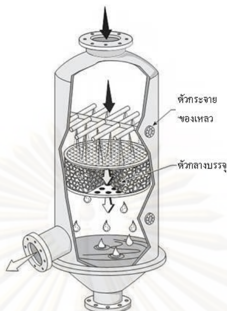
รูปที่ 2.8 แพคเบตสครับเบอร์ที่มีกระแสการไหลทางเดียวกัน (Richards, 2000)
