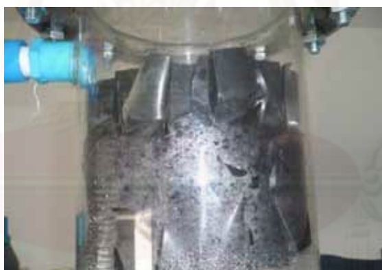
รูปที่ 3.10 การติดตั้งอุปกรณ์ดักจับละอองน้ำ
