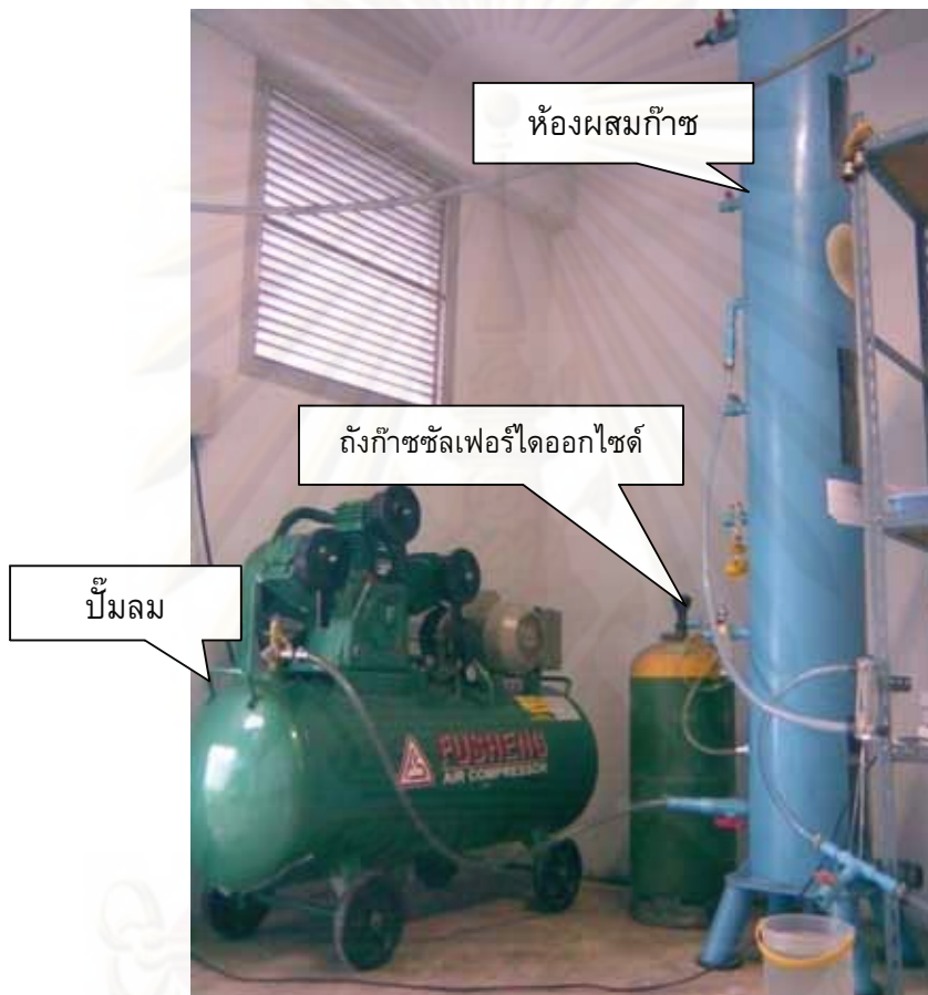
รูปที่ 3.4 ระบบการผสมก๊าซซัลเฟอร์ไดออกไซด์
