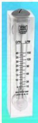
รูปที่ 3.18 โรตاميเตอร์สำหรับวัดอัตราการไหลก๊าซ
