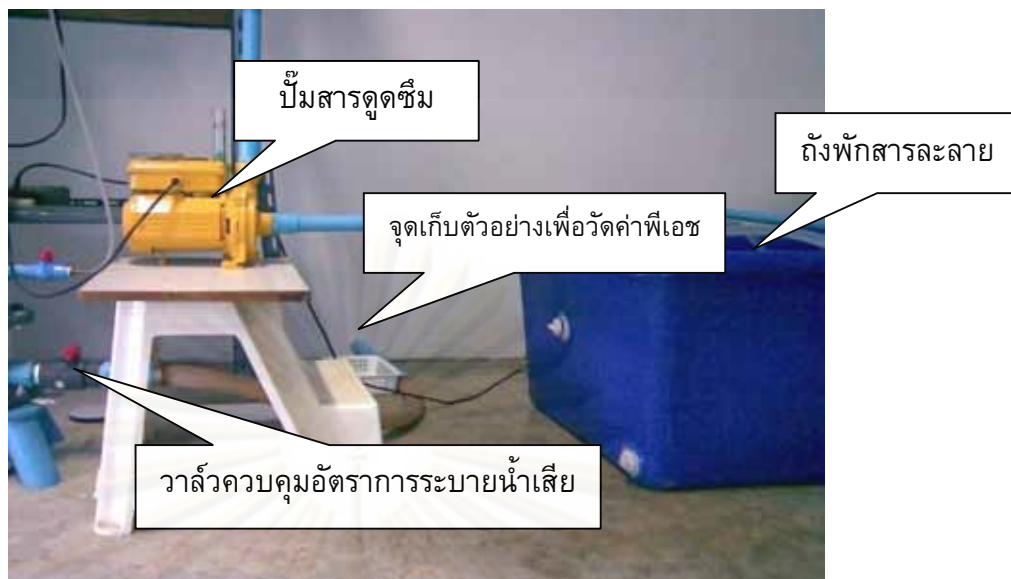
รูปที่ 3.11 การติดตั้งระบบสารดูดซึมและการระบายน้ำเสีย
