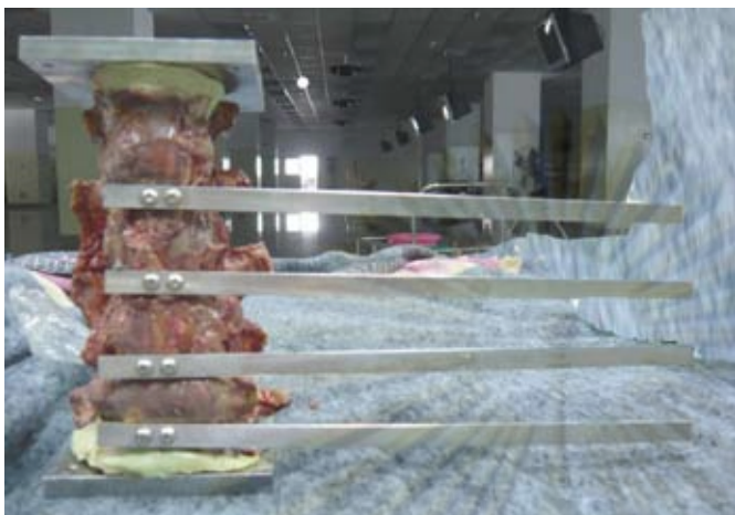
รูปที่ 6 การติดก้านเหล็กวัดมุมในแนว coronal
