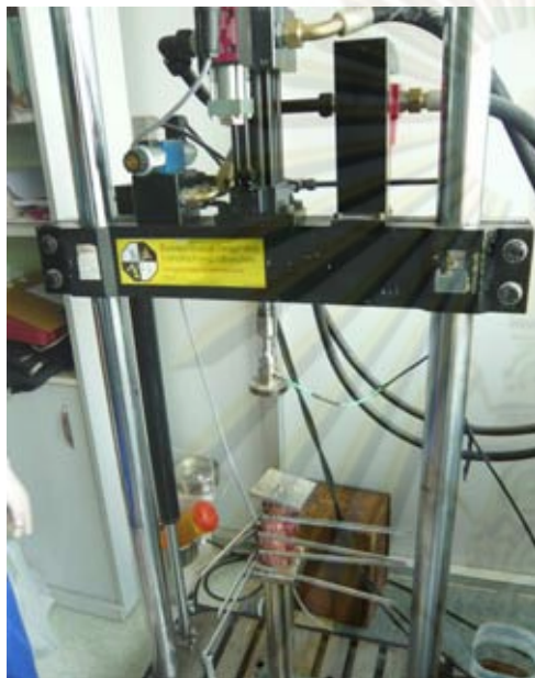
รูปที่ 9 การประกอบ specimen กับแท่นทดลอง โดยในขั้นตอนแรกจะมีการติดกับแท่นทดลองด้านล่าง
