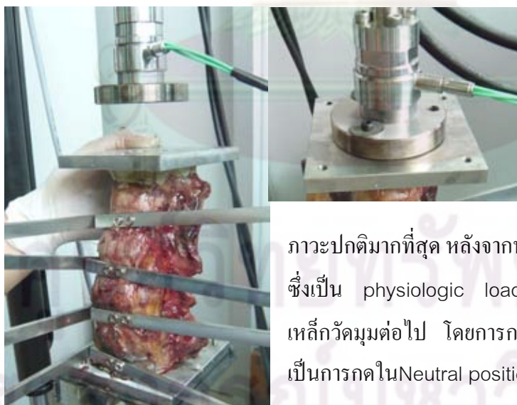
รูปที่ 10 apply axial load 700 N. ซึ่งเป็น physiologic load
