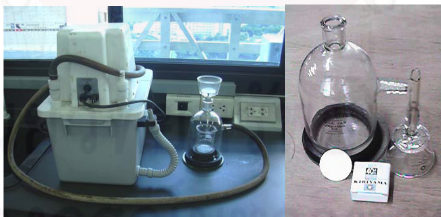
รูปที่ 3.3 ชุดกรองสุญญากาศ และกระดาษกรองใยแก้ว
