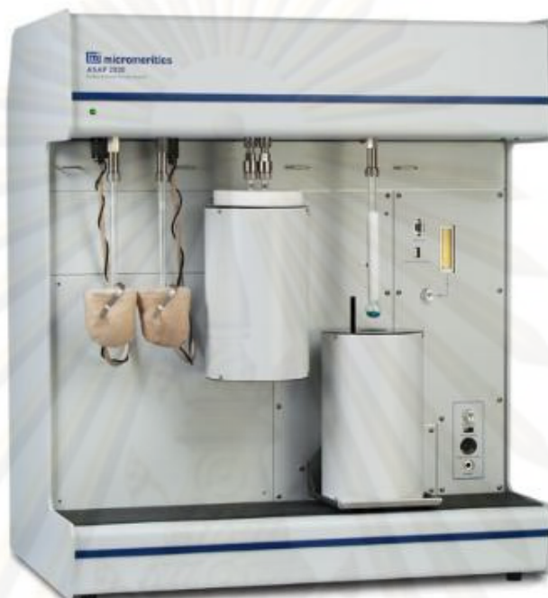
รูปที่ 3.6 เครื่อง BET surface area analysis [5]
