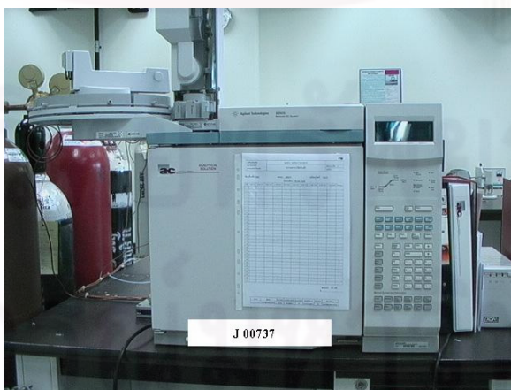
รูปที่ 3.4 เครื่องแก๊สโครมาโทกราฟีจำลองการกลั่น (Simulated Distillation Gas Chromatography : Varian CP-3800 [12])
