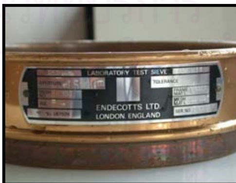
รูปที่ 6 ตะแกรงลวดเส้นผ่านศูนย์กลางของรู 0.0059 นิ้ว
