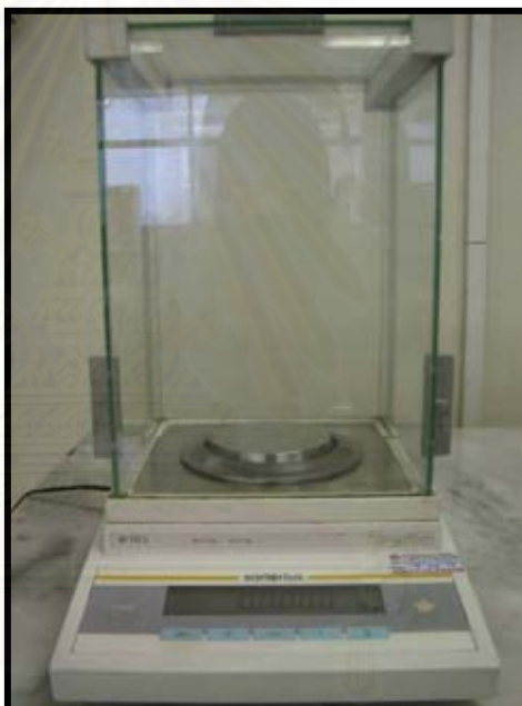
รูปที่ 2 เครื่องชั่งไฟฟ้าแบบละเอียดทศนิยม 4 ตำแหน่ง
