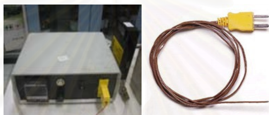
รูปที่ 3.5 เทอร์โมคัปเปิ้ลวัดอุณหภูมิและเครื่องควบคุมอุณหภูมิ
