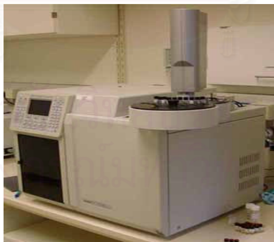
รูปที่ 3.6 เครื่องแก๊สโครมาโทกราฟี (Gas Chromatography / Flame Ionized Detector / Thermal Conductivity Detector , GC/FID/TCD).
