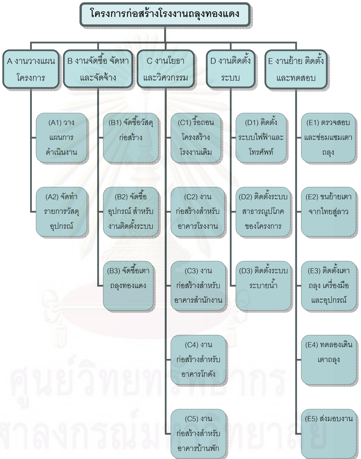
รูปที่ 5.1 โครงสร้างการจำแนกงาน (Work Breakdown Structure) ของโครงการก่อสร้างโรงงาน
