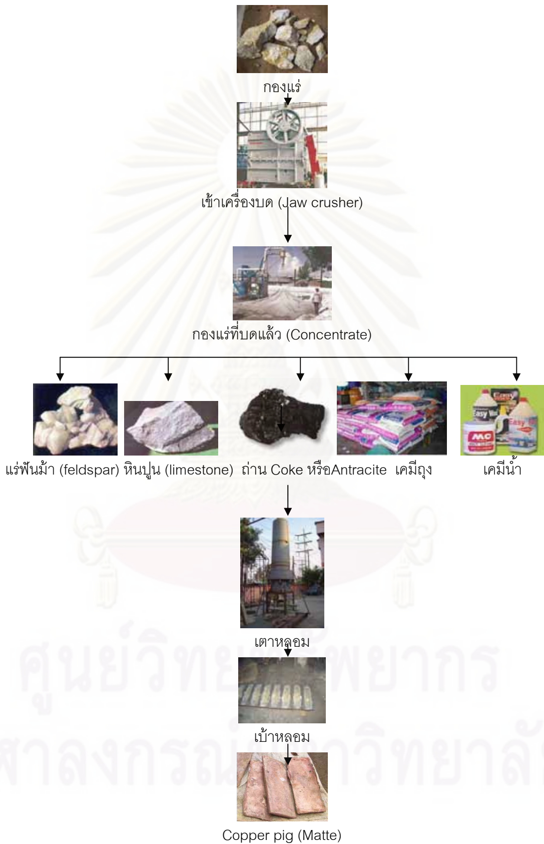
รูปที่ 3.11 ขั้นตอนการหลอมแร่ทองแดงคาร์บอน (มาลาไคต์) ผ่านเตาคิวโปลา (Capola Furnace)
