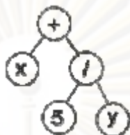
ภาพที่ 2-30 การเข้ารหัสแบบ Tree Encoding
