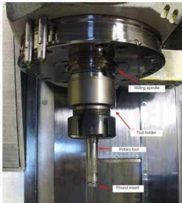
รูปที่ 4.9 การประกอบมีดกลึงแบบโรตารีเข้ากับเครื่อง CNC
