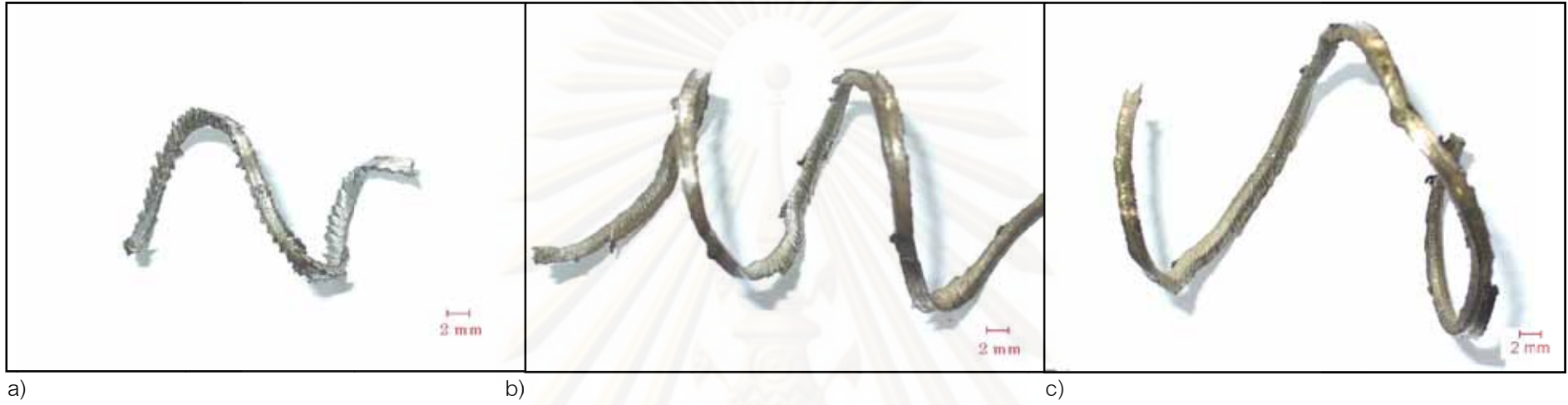
รูปที่ 3.11 เศษกลิ้งที่อัตราป้อน 0.74 mm/rev จากมีดกลิ้ง a) R_a = 1.55 \mu\text{m} b) R_a = 0.25 \mu\text{m} c) R_a = 0.06 \mu\text{m}
