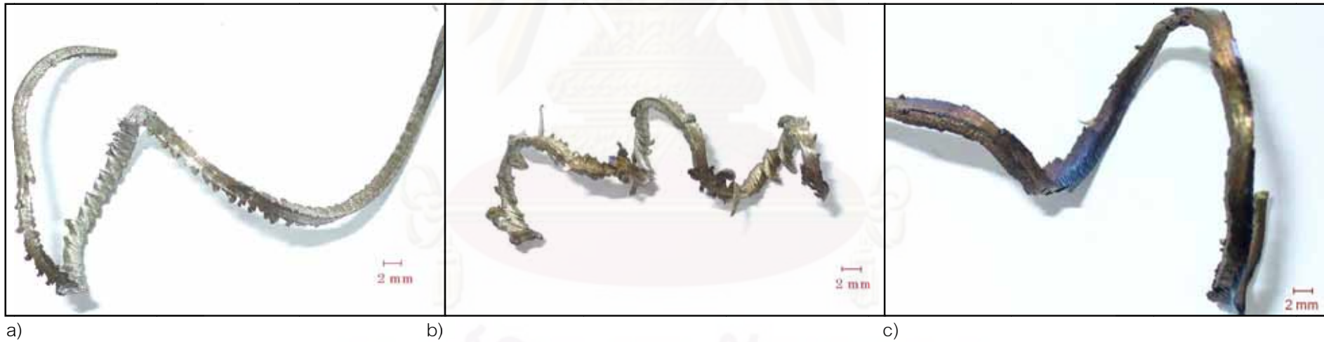
รูปที่ 3.12 เศษกลิ้งที่อัตราป้อน 0.82 mm/rev จากมีดกลิ้ง a) R_a = 1.55 \mu\text{m} b) R_a = 0.25 \mu\text{m} c) R_a = 0.06 \mu\text{m}
