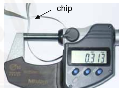
รูปที่ 9 การวัดความหนาเศษกลึงที่ feed 0.4 mm/rev ด้วยไมโครมิเตอร์ a)เม็ดมีดอยู่กับที่ b)เม็ดมีดหมุน
