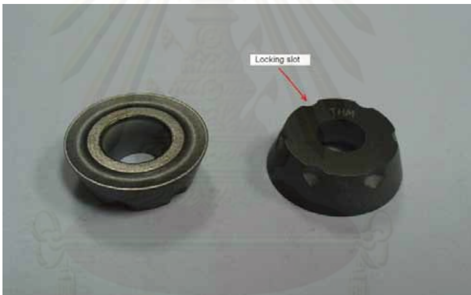
รูปที่ 4.7 เม็ดมีดลึง widia RDMT1605M0T-X ขนาดเส้นผ่านศูนย์กลาง 16 mm
