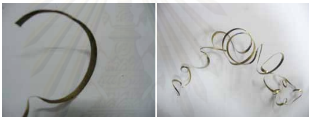
รูปที่ 5.14 เศษกึ่งที่ได้จากการกึ่งด้วยมีดกึ่งแบบโรตารี
