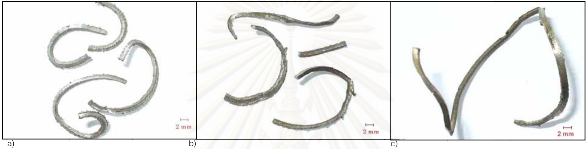
รูปที่ 3.9 เศษกึ่งที่อัตราป้อน 0.54 mm/rev จากมีดกลึง a) R_a = 1.55 \mu\text{m} b) R_a = 0.25 \mu\text{m} c) R_a = 0.06 \mu\text{m}
