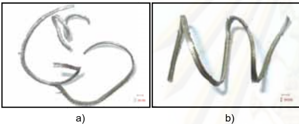
รูปที่ 11 แสดงเศษกึ่งที่ได้จากการทดลอง a) มีดกึ่ง R_a = 1.55 \mu m b) มีดกึ่ง R_a = 0.06 \mu m
