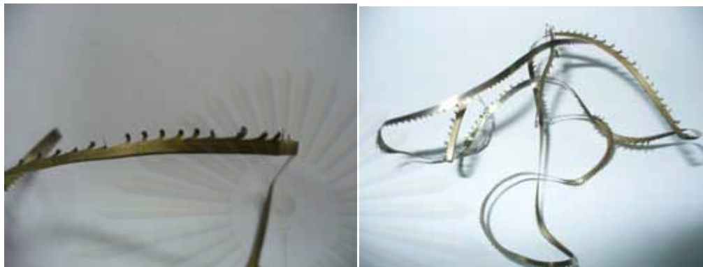
รูปที่ 5.13 เศษกึ่งที่ได้จากการกึ่งด้วยมีดกึ่งแบบอยู่กับที่
