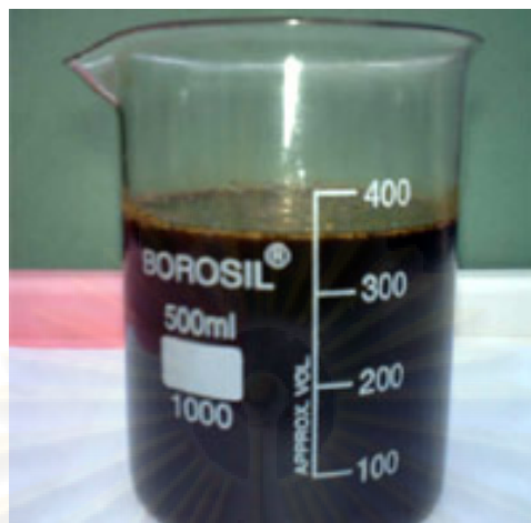
รูปที่ 2.3 ก्लीเซอรอลเหลือทิ้ง (Waste glycerol)
