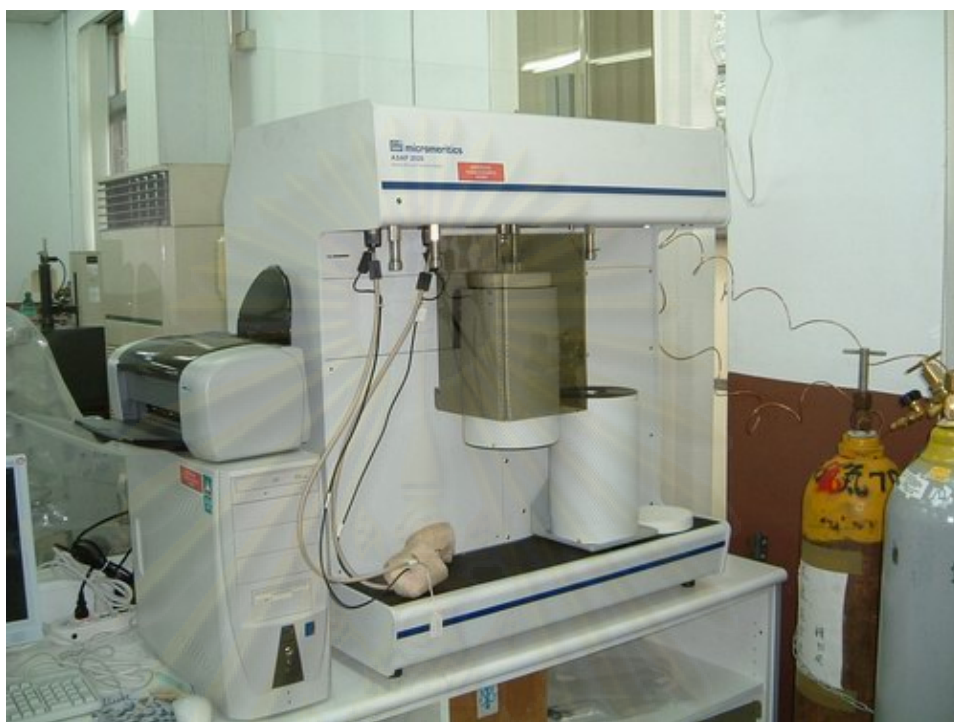
รูปที่ 3.6 เครื่องวัดพื้นที่ผิวและขนาดของรูพรุน (BET Surface Area)
