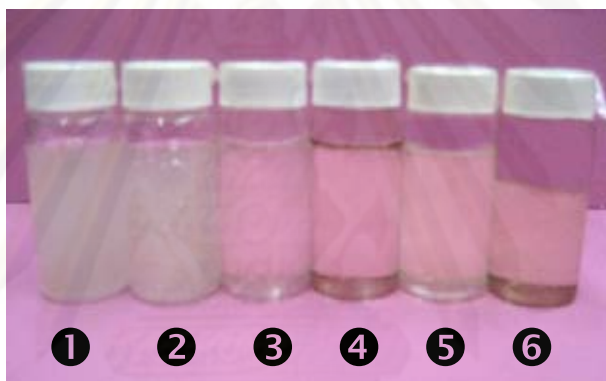
รูปที่ 3.22 น้ำมันมะพร้าวผ่านกรรมวิธีกับตัวทำละลายเมื่อทำการเขย่าให้เข้ากัน (1-น้ำเปล่า 2-Xylene 3-N-Butanol 4- Ethyl Alcohol 5-Diesel Oil 6- Refined Coconut Oil)
