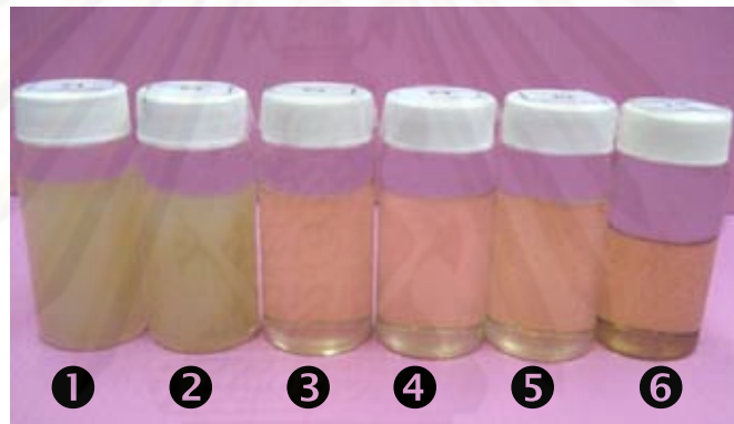
รูปที่ 3.25 น้ำมันหมูผ่านกรรมวิธีกับตัวทำละลายเมื่อทำการเขย่าให้เข้ากัน (1-น้ำเปล่า 2-Xylene 3-N-Butanol 4- Ethyl Alcohol 5-Diesel Oil 6-Lard Oil)
