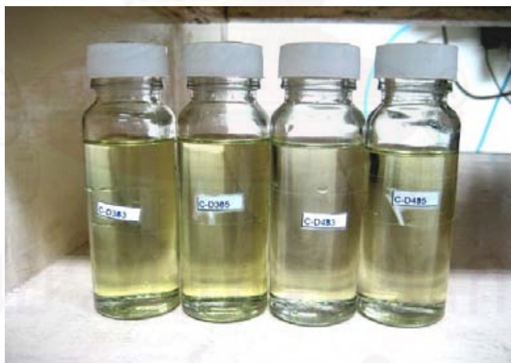
รูปที่ 3.39 น้ำมันมะพร้าวผ่านกรรมวิธีผสมน้ำมันดีเซลหลังทำการฉายรังสี
