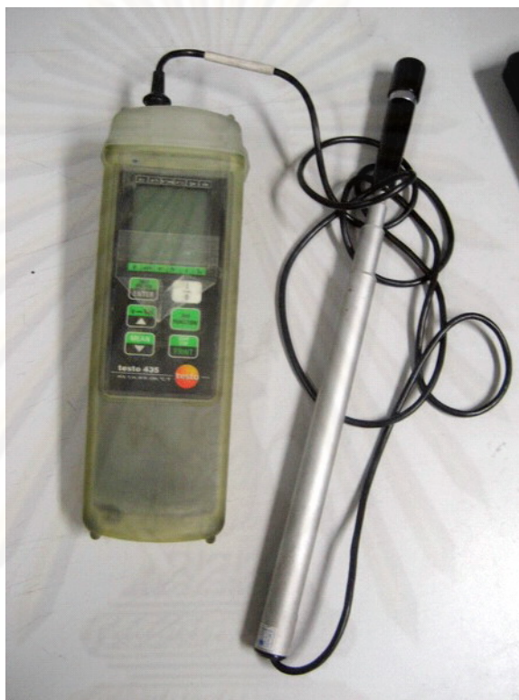
รูปที่ 3.13 เครื่องมือวัดความเร็วลมชนิดหลายฟังก์ชัน (Multi-Function) รุ่น Testo 435
