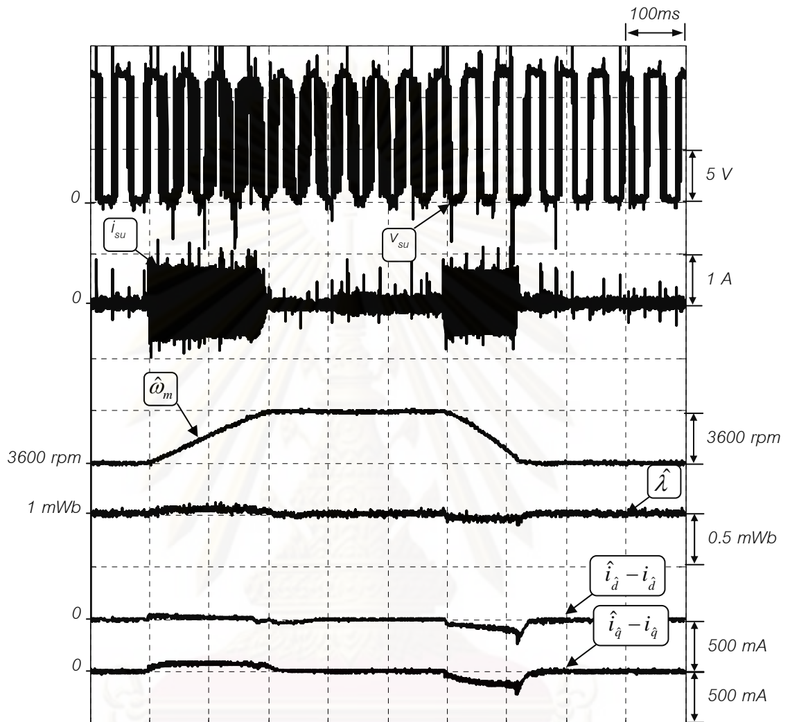
รูปที่ 3.19 ผลการทดลองการเร่งลดความเร็วของระบบควบคุมเวกเตอร์แบบไร้เซนเซอร์วัดตำแหน่งเมื่อใช้อินเวอร์เตอร์ PWM โดยไม่มีการติดตั้งตัวเข้ารหัสและไม่มีแผ่นดิสก์ข้อมูล
