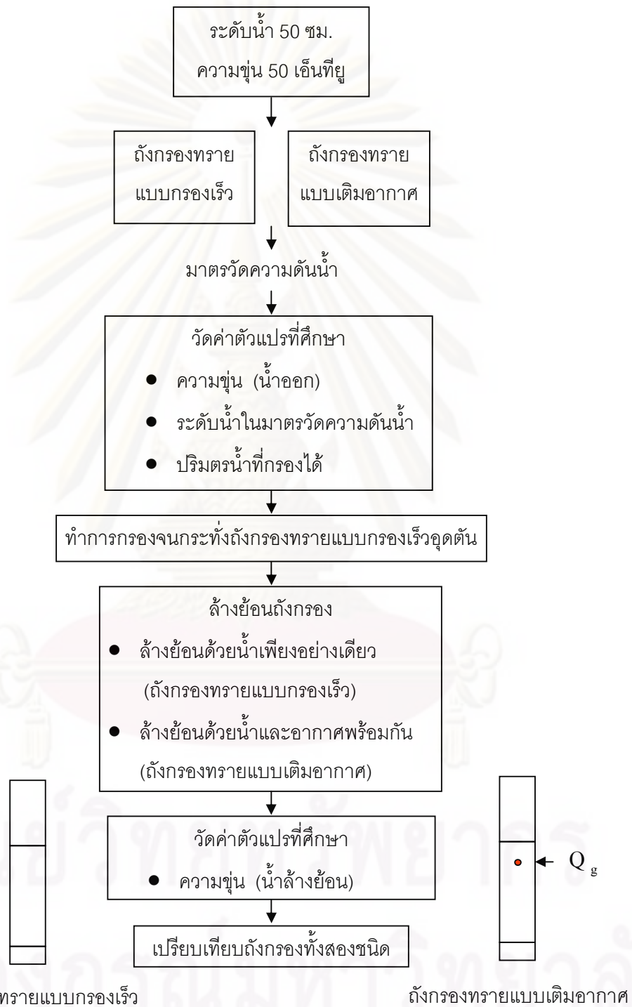
รูปที่ 3.6 ขั้นตอนการเปรียบเทียบถังกรองทรายแบบกรองเร็วกับถังกรองทรายแบบเต็มอากาศ
