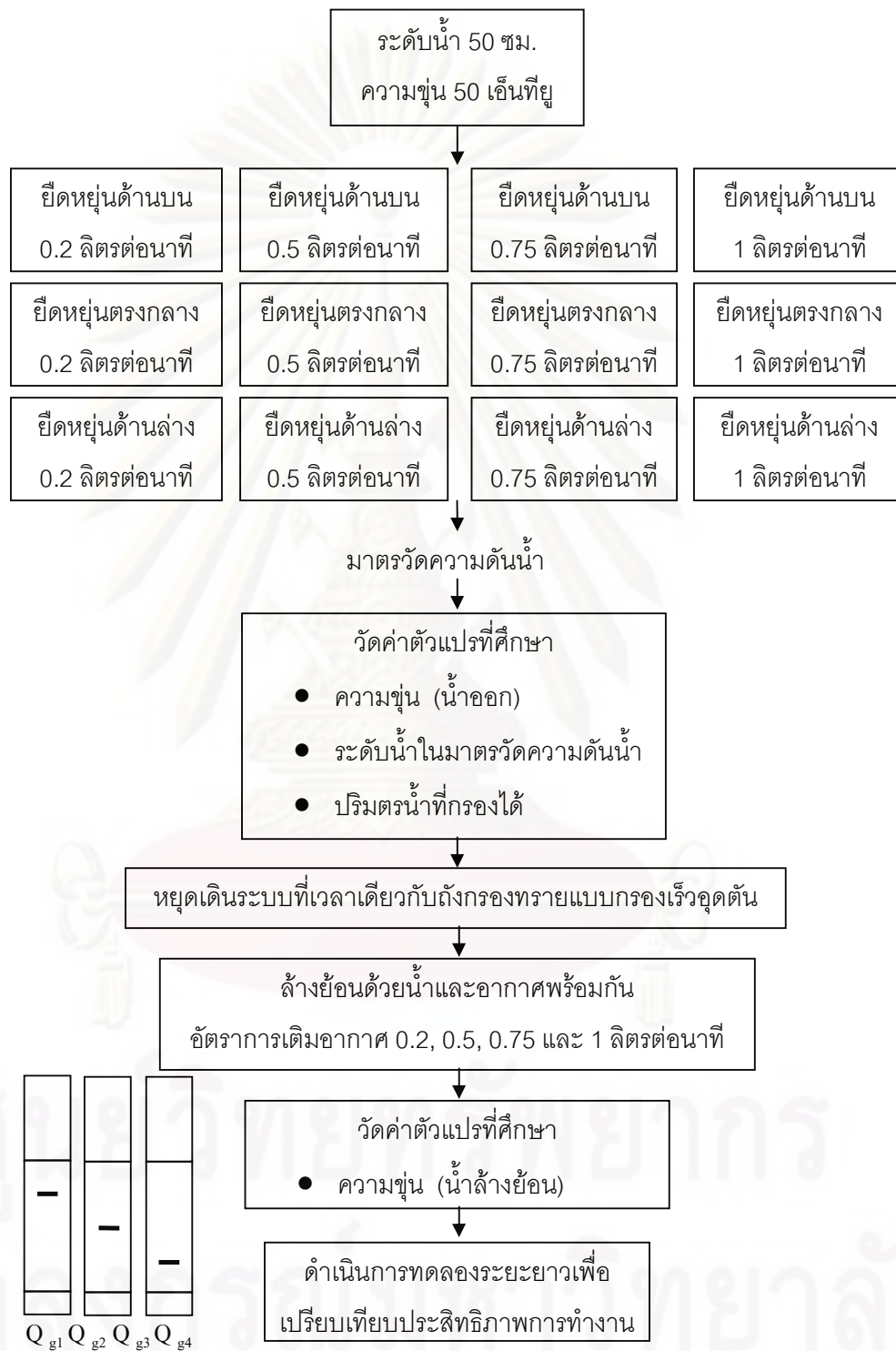
รูปที่ 3.8 ขั้นตอนการศึกษาผลกระทบจากชนิดของอุปกรณ์เติมอากาศแบบยี่ดยุ่น
