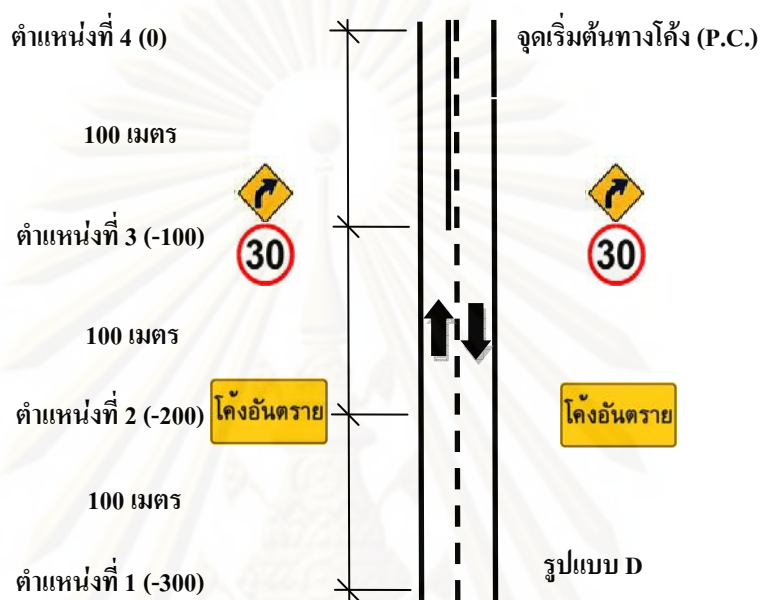
ภาพที่ 3.4 การติดตั้งป้ายจำกัดความเร็วรูปแบบ D
