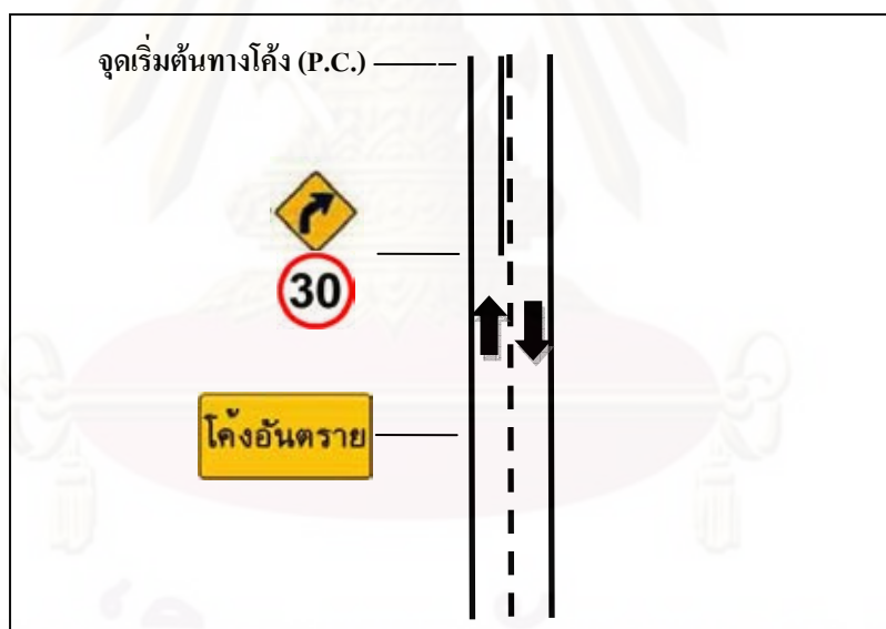
ภาพที่ 6.3 การติดตั้งป้ายจำกัดความเร็วรูปแบบ C
