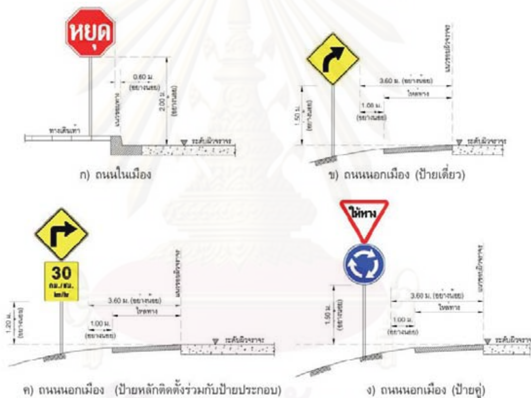
ภาพที่ 2.6 ระยะการติดตั้งป้ายบริเวณข้างทาง ที่มา: คู่มือและมาตรฐานป้ายจราจร เล่มที่ 1, สนข. (2547)
