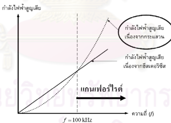
รูปที่ 2.16 กราฟเปรียบเทียบกำลังไฟฟ้าสูญเสียเนื่องจากฮีสเทอรีซิสและกระแสวนของเฟอร์ไรต์ที่ความถี่ต่างๆ
