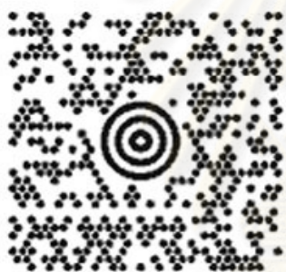
(ก) รูปภาพแสดงลักษณะทางกายภาพของ รหัสแท่ง 2 มิติแบบแม็กซ์โค้ดแบบสี่เหลี่ยม
