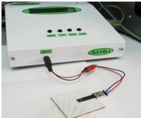
รูปที่ 3.3 วิธีการวัดสารละลายกับเครื่องโพเทนทีโอสแตด
