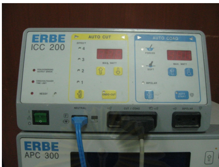
รูปที่ 18 แสดงเครื่องกำเนิดพลังงาน ERBE ICC 200 สำหรับการตัดหูดท่อน้ำดีด้วย needle-knife หรือ sphincterotomy
