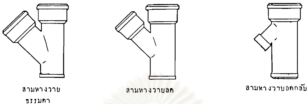
รูปที่ 4 ข้อต่อท่อเหล็กหล่อสามทางวาย 45°
