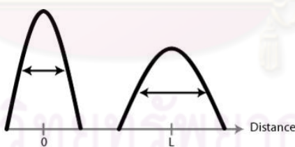
รูปที่ 2.3 ผลของดิสเพอร์ชันต่อสัญญาณที่เดินทางในเส้นใยแสง
