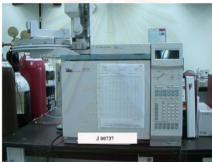
รูปที่ 3.4 เครื่องแก๊สโครมาโทกราฟแบบจำลองการกลั่น (Simulated Distillation Gas Chromatograph: Varian CP-3800)
