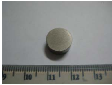
รูปที่ 3.4 ชิ้นงานผงโลหะผสมไทเทเนียมและทองแดงที่ผ่านการขึ้นรูปเย็น
