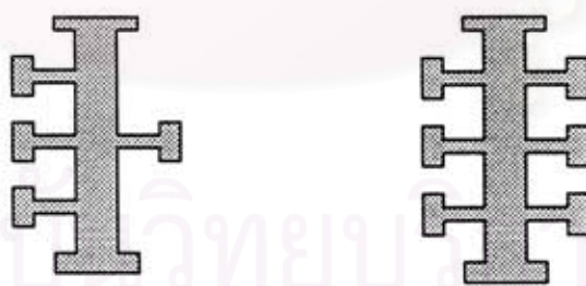
รูปที่ 2.4 รูปทรงสารตัวอย่างแบบฮอลล์บาร์ชนิด 6 และ 8 แขน
