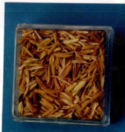
รูปที่ 4.1 ลักษณะของแกลบที่ผ่านการล้างด้วยน้ำ
