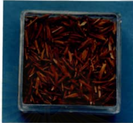
รูปที่ 4.2 ลักษณะของแกลบที่ผ่านการต้มกับกรดไฮโดรคลอริกความเข้มข้น 1 โมลต่อลิตร เป็นเวลา 3 ชั่วโมง
