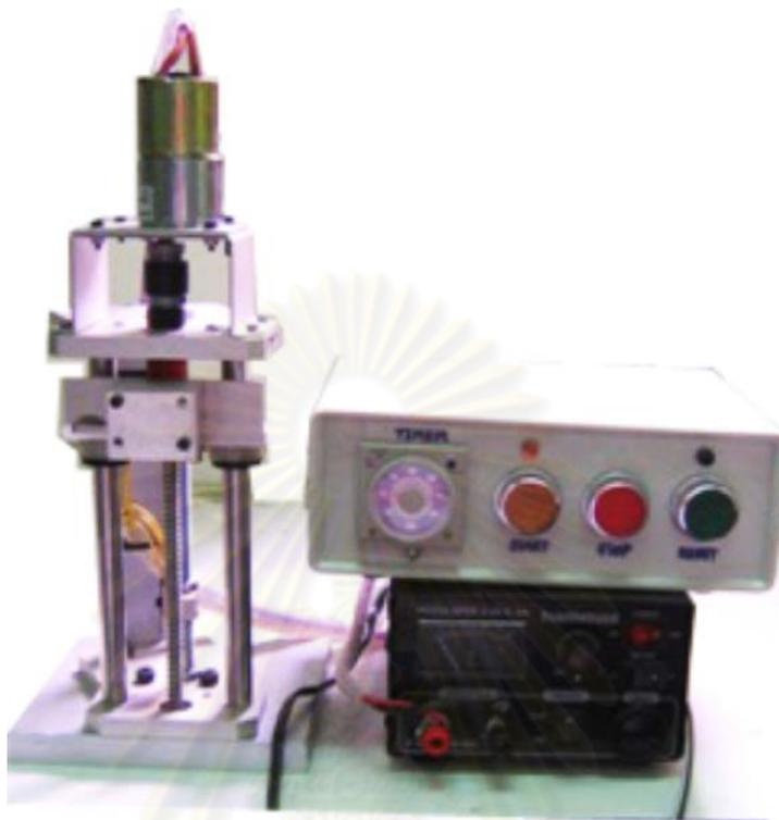
**Figure 2.3** Dip coater machine (CEPT, CU)
