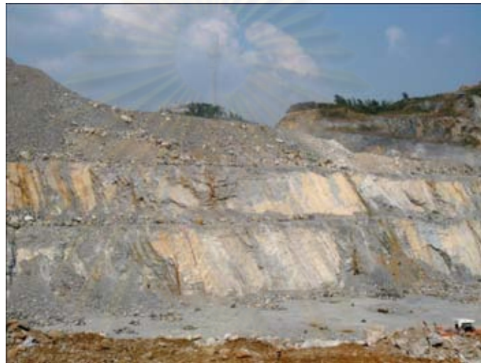
รูปที่ 4.7 ผนังบ่อเหมืองที่มีโอกาสเกิดการพังทลายแบบระนาบ
