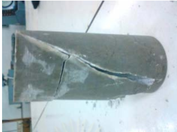
รูป ข10 แท่งหินตัวอย่างหลังทำการทดสอบ
