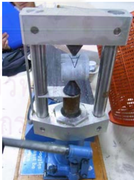
รูปที่ ข3 การทดสอบดัดชนิดจุดแบบการแนวด้านข้าง
