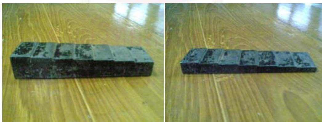
ภาพที่ 3.4 ชิ้นงานทดสอบรูปทรงขั้นบันได (step wedge)
