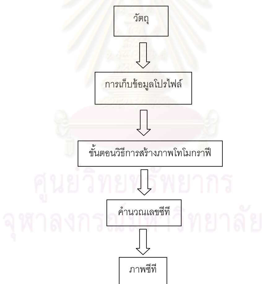
ภาพที่ 2.8 ขั้นตอนของกระบวนการสร้างภาพโทโมกราฟีและค่าเลขซีที
