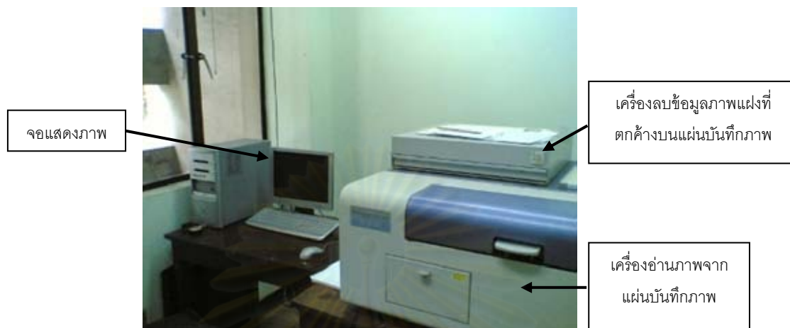
ภาพที่ 3.3 เครื่องอ่านภาพจากแผ่นบันทึกภาพและเครื่องลบข้อมูลภาพแฝงที่ตกค้างบนแผ่นบันทึกภาพ
