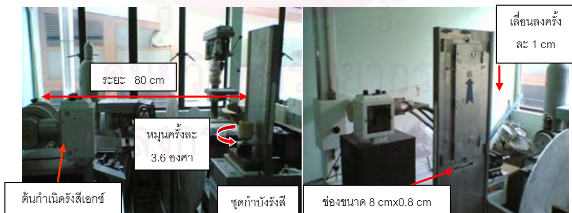
ภาพที่ 3.12 การจาจัดระบบการถ่ายภาพด้วยรังสีเอกซ์
