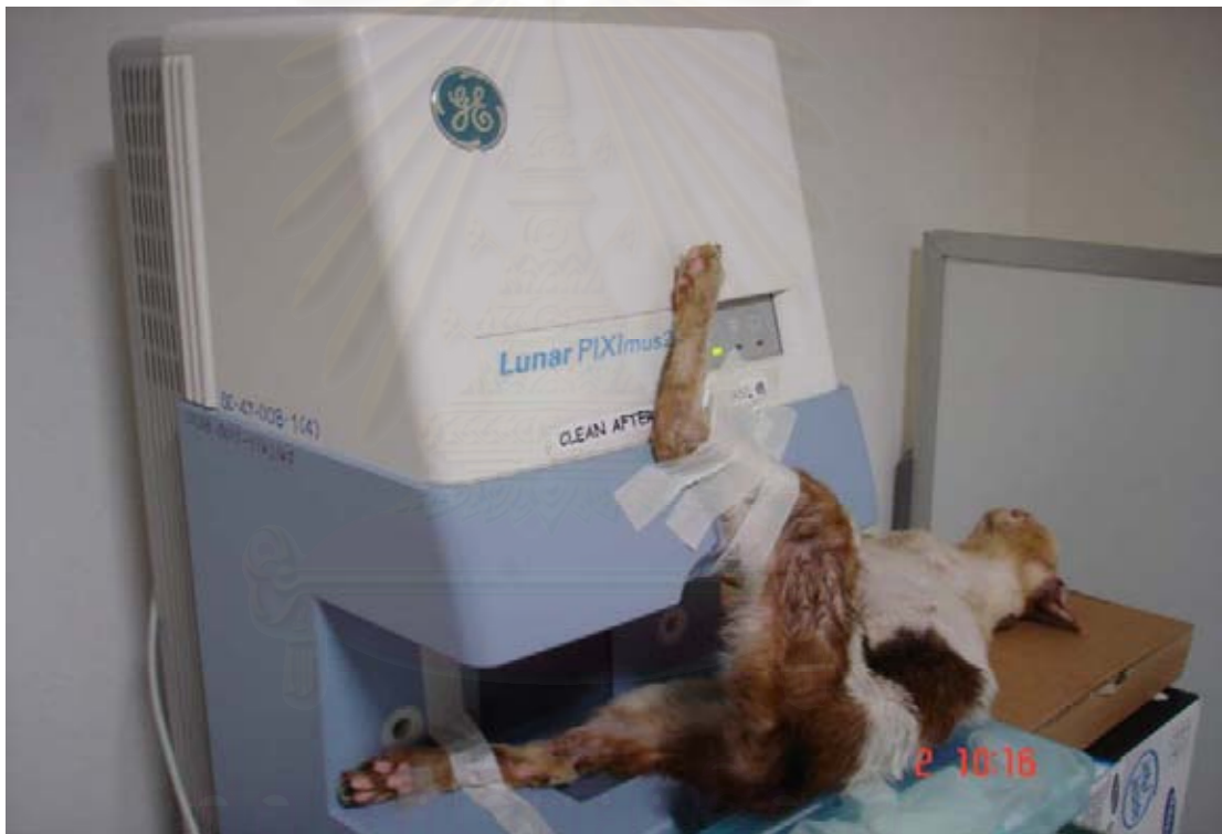
ภาพที่ 19 แสดงการจัดท่าของแมวในการวัดความหนาแน่นของกระดูกด้วยเครื่อง LunarPIXImus 2
