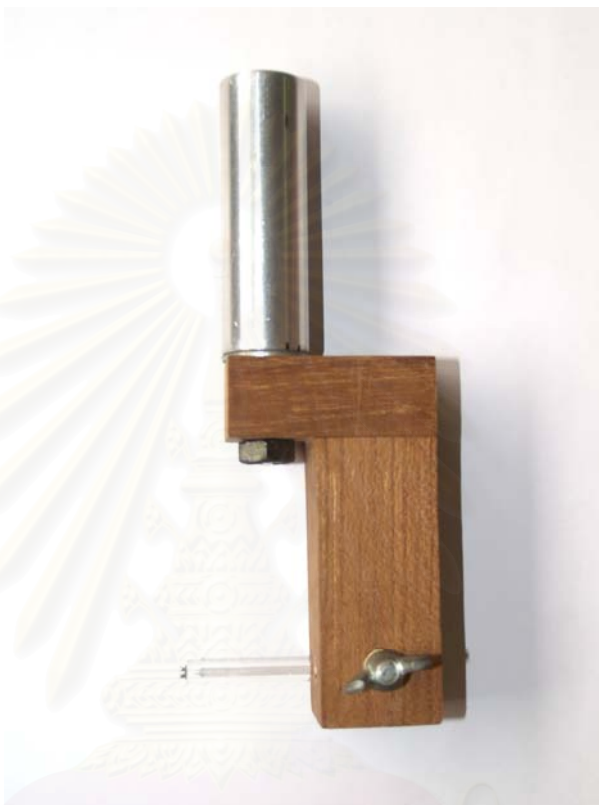
รูปที่ 36 เครื่องมือสำหรับยึดแท่งอะคริลิก และต่อกับส่วนโครงสร้างของเครื่องลอยด์ยูนิเวอร์แซลทดสอบดึงแมชชีน
