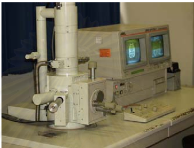
รูปที่ 39 กล้องจุลทรรศน์อิเล็กตรอนแบบส่องกราด
