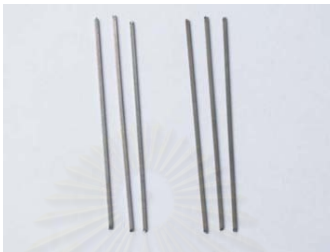
รูปที่ 62 การเปรียบเทียบสีของลวดเบตาไทเทเนียมจากกลุ่มควบคุม (ซ้าย) และจากกลุ่มที่ผ่านการแช่ในสารละลายจากเจลฟลูออไรด์ชนิดเคลือบ (ขวา)
