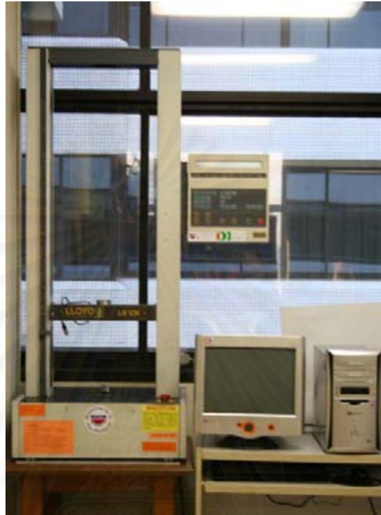
รูปที่ 37 เครื่องลอยด์ยูนีเวอซัลทดสอบดึงแมชชีน
