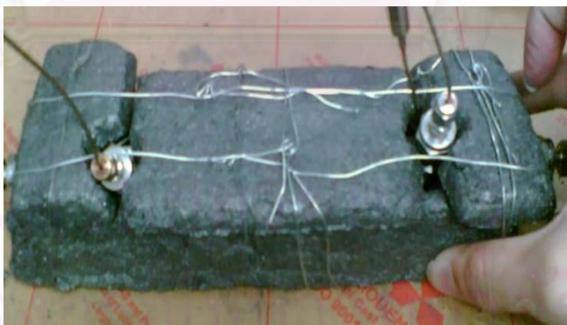
รูปที่ 3.7 เครื่องปฏิกรณ์แบบท่อที่พันขดลวดให้ความร้อนและประกบด้วยปูนซีเมนต์
