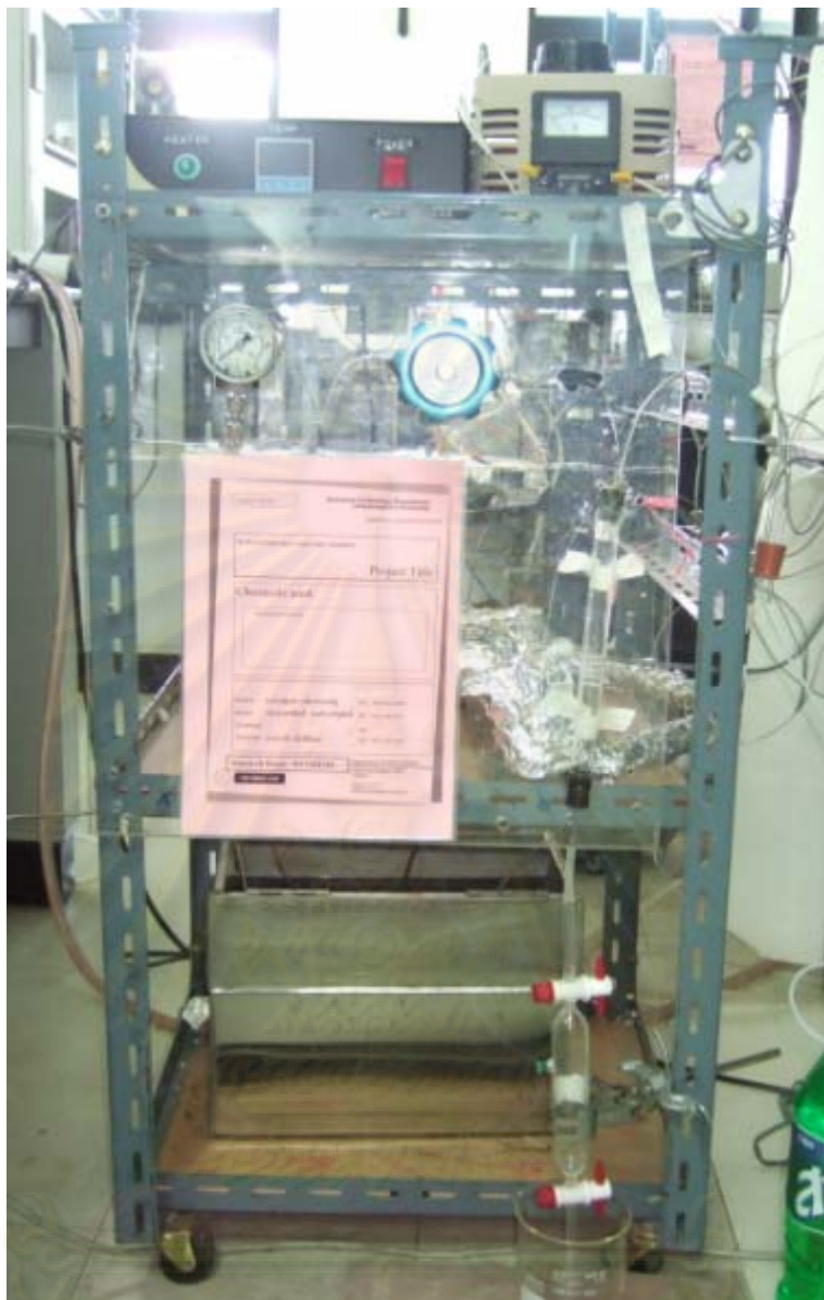
รูปที่ 3.2 เครื่องปฏิกรณ์เชิงเร่งปฏิกิริยาขนาดกะทัดรัดสำหรับปฏิกิริยาออกซิเดชันของแอสีโทไนโตรลีนในน้ำภาวะเหนือวิกฤต
