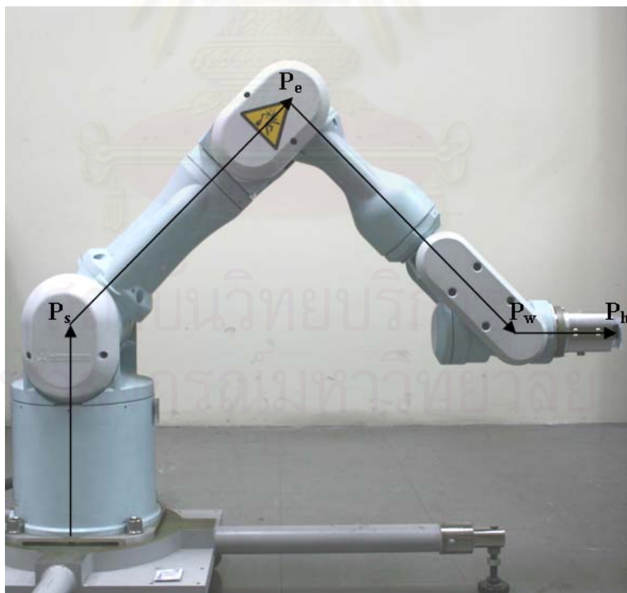
รูปที่ 3.4: ตำแหน่งหัวไหล่( \mathbf{p}_s ) ข้อศอก( \mathbf{p}_e ) ข้อมือ( \mathbf{p}_w ) และ ปลายแขน( \mathbf{p}_h )
