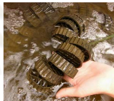
ถังชุดตัวกรองที่ตรงหัวเชื้อแล้ว (วันที่ 90)
