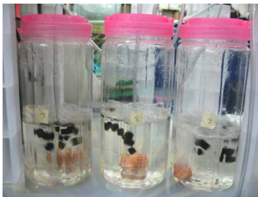
รูปที่ 3.8 การทดสอบอัตราการบำบัดแอมโมเนียของตัวกรองชีวภาพที่บ่มในถังปฏิกรณ์ที่ระดับความเข้มข้นแอมโมเนียต่างกันด้วยกระบวนการไนตริฟิเคชัน
