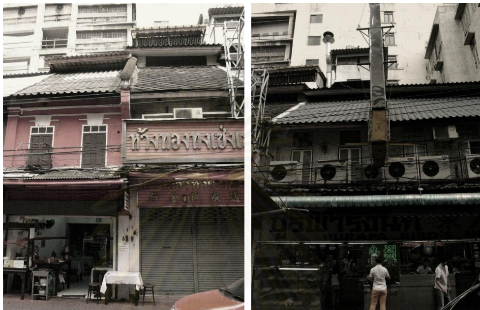
ภาพที่ 4.10 แสดงการเปลี่ยนแปลงรูปทรงโดยต่อเติมชั้น 3 จากหลังสันหลังคาจั่วตลอดความยาวอาคารของอาคารตึกแถว ถนนแปลงนาม
