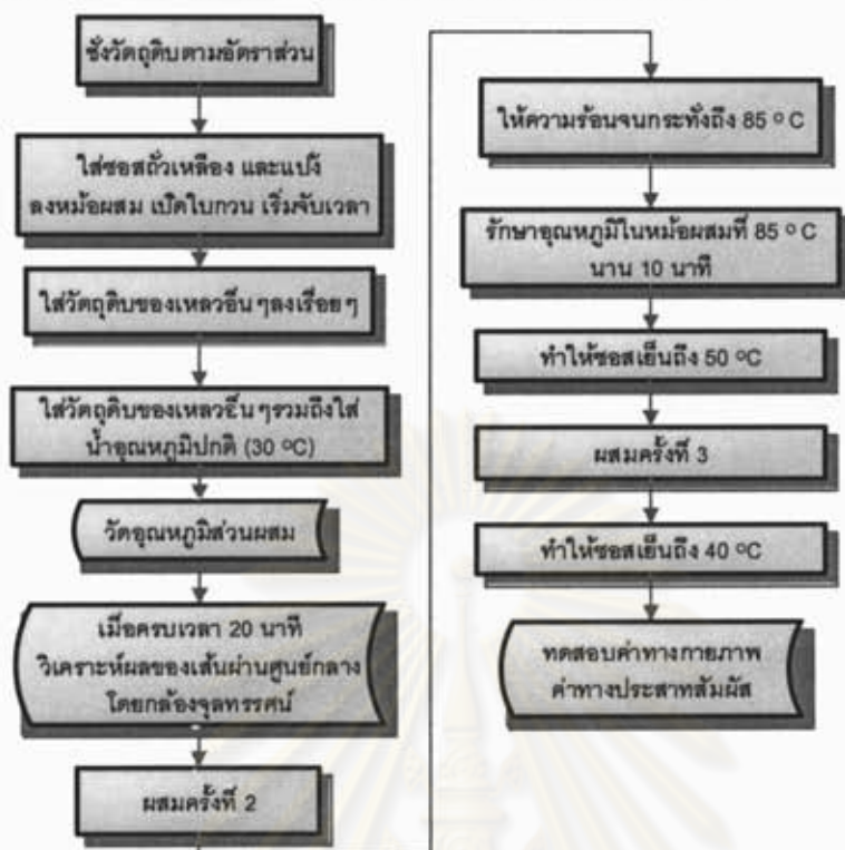
รูปที่ 4.20 ขั้นตอนการทดสอบในกระบวนการใหม่ที่อุณหภูมิน้ำ 30°C
