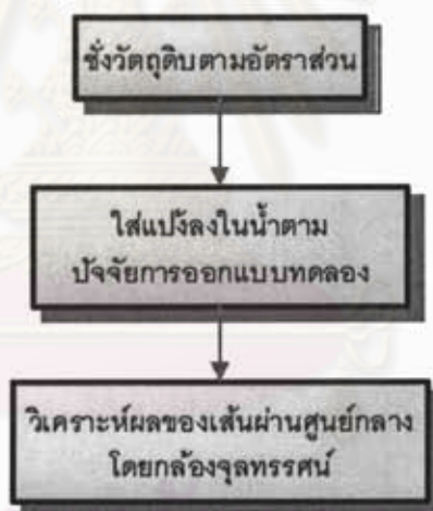
รูปที่ 4.12 ขั้นตอนการทดสอบการบวมของเม็ดแป้งต่อเวลาและอุณหภูมิ
