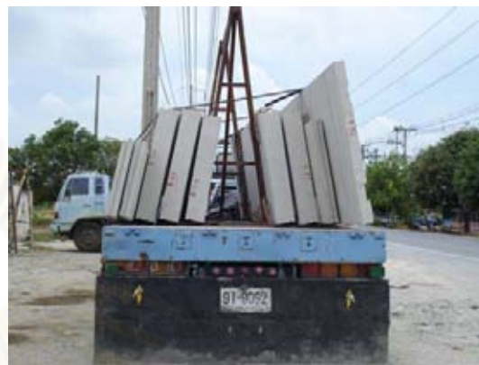
ภาพที่ 5.72 รถบรรทุก 10 ล้อขนส่ง 8-9 แผ่นต่อเที่ยว
