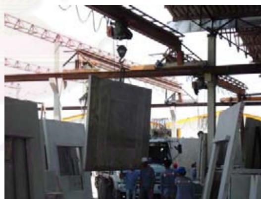
ภาพที่ 5.70 การยกชิ้นส่วนขึ้นรถพร้อมส่งไป หน่วยงาน
