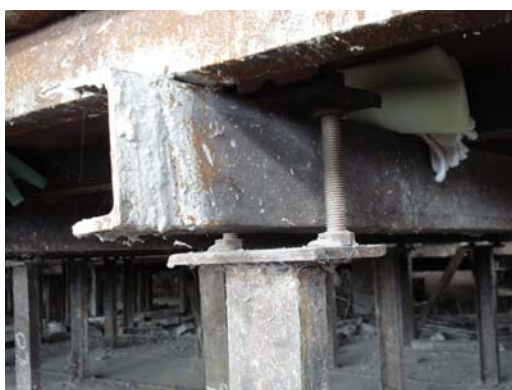
ภาพที่ 5.41 ลานหล่อปรับระดับได้โดยใช้เกลียวขัน
