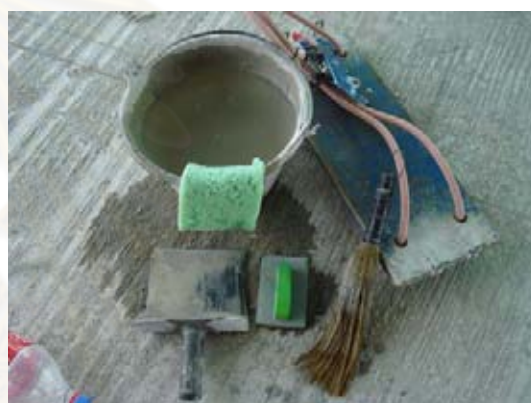
ภาพที่ 5.217 แสดงเครื่องมือที่ใช้ตักแต่งผิว ผนังนอกอาคาร
