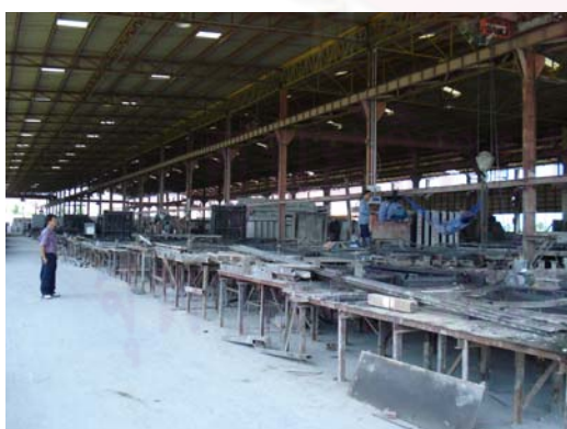
ภาพที่ 5.39 ลานหล่อชิ้นส่วนสำเร็จรูป Line 3
