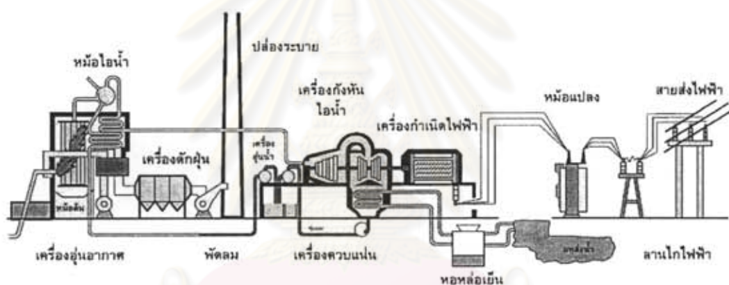
รูปที่ 2.1 แสดงการผลิตไฟฟ้าจากชีวมวลด้วยการเผาไหม้โดยตรง (นเรศ สัตยารักษ์ และคณะ, 2549)
