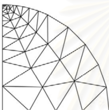
(ค) โครงข่ายชิ้นส่วนที่ 8 ของงานวิจัยเดิม ที่ใช้ชิ้นส่วนสามเหลี่ยมที่มีความละเอียดคงที่ Error = 0.0495 Nn = 151 Ne = 60
