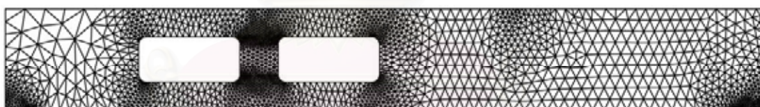
(ค) โครงข่ายชิ้นส่วนที่ 4 ของงานวิจัยนี้ ที่ใช้ชิ้นส่วนสามเหลี่ยมอย่างง่ายพร้อมการหมุนที่จุดยอด ร่วมกับการปรับปรุงการส่งข้อมูลที่ไม่ใช้ในการสร้างชิ้นส่วนรอบถัดไป Error = 0.0438 Nn = 2182 Ne = 3896
