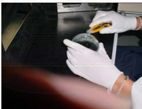
รูปที่ 5.1 การให้มีดกรีดในการแยกแม่แบบออกจากเลนส์
