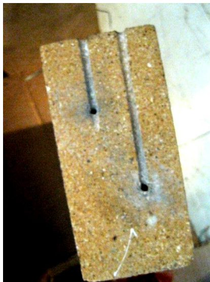
รูปที่ 5-4 ลักษณะอิฐที่มีการเจาะและเซาะร่องเพื่อเดินสาย Thermocouple
