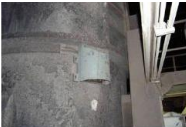
รูปที่ 2-27 ลักษณะชุดส่งสัญญาณที่ภายในติดตั้ง Passive RFID ไว้เพื่อส่งสัญญาณการตรวจวัด อุณหภูมิผนังเข้าน้ำเหล็กกระยะไกลของ Dannert
