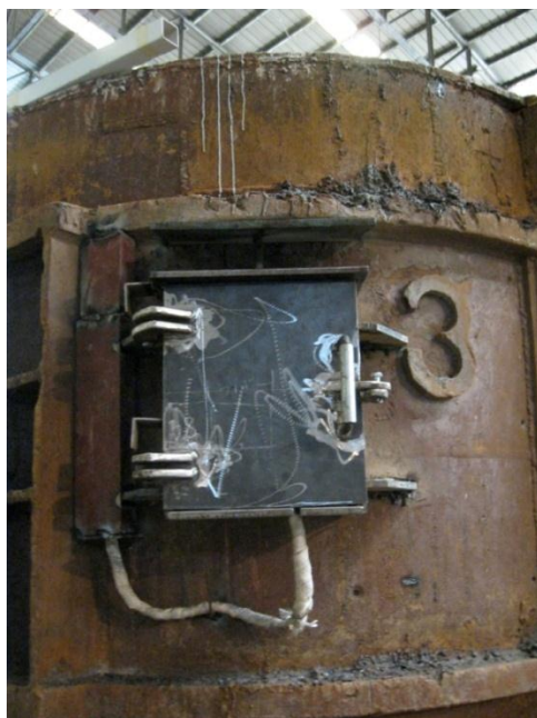
รูปที่ 5-5 ลักษณะอุปกรณ์ป้องกันความร้อนและแรงกระแทก
