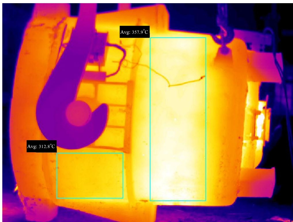
รูปที่ 5-13 ภาพถ่ายความร้อนผนังภายนอกเบ้ารับน้ำเหล็กขณะล้างรูเทด้วยออกซิเจน
