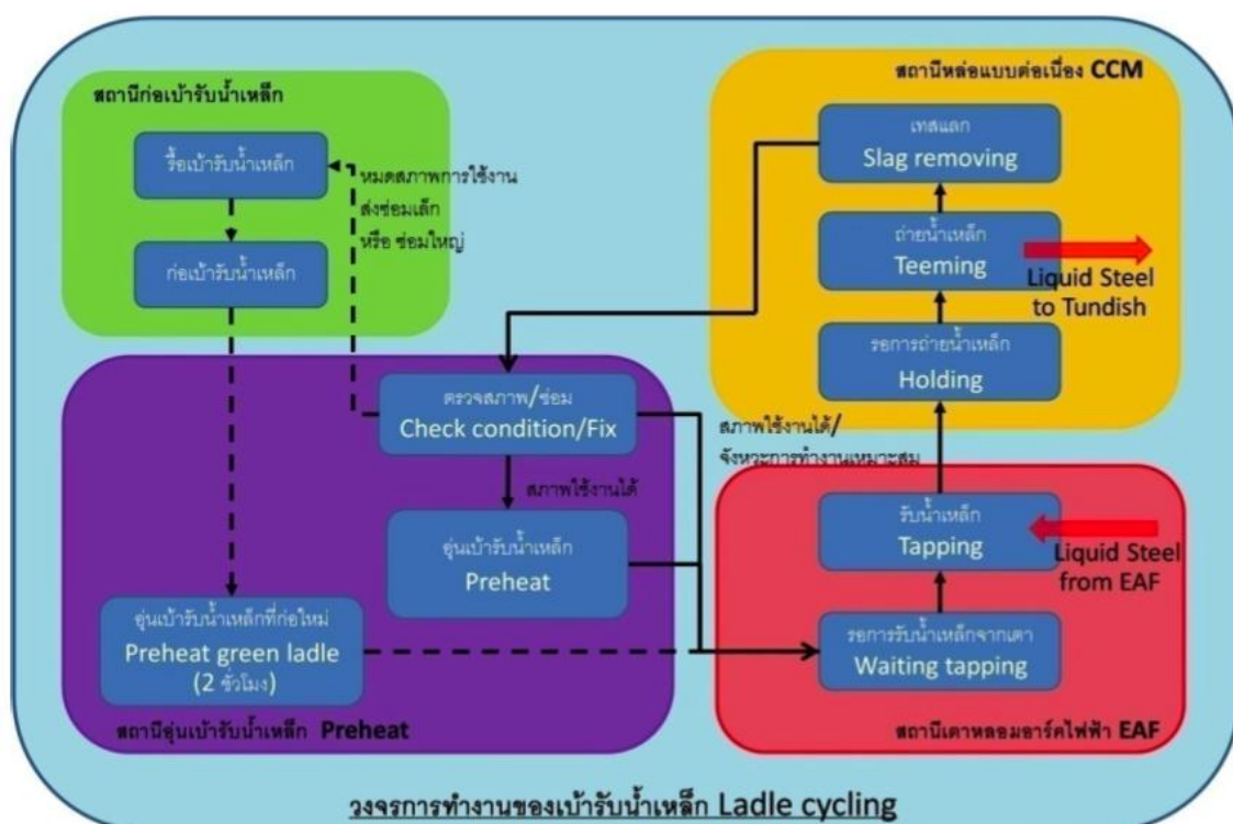
รูปที่ 3-7 วัฏจักรการทำงานของเบ้ารับน้ำเหล็ก (ศิริพงษ์ ชื่นกลิ่น, 2552)
