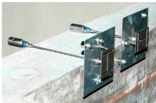
รูปที่ 2-26 ลักษณะการฝัง Thermocouple แล้วต่อสายสัญญาณออกมาหา SAW ด้านนอกผนังเบ้ารับน้ำเหล็ก (Fachebeger และ Erlacher, 2010)
