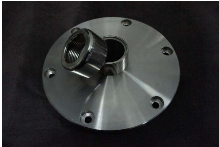
ภาพที่ 3.11 แป้นฝาส่วนบนพร้อมฝาครอบที่สร้างขึ้น
