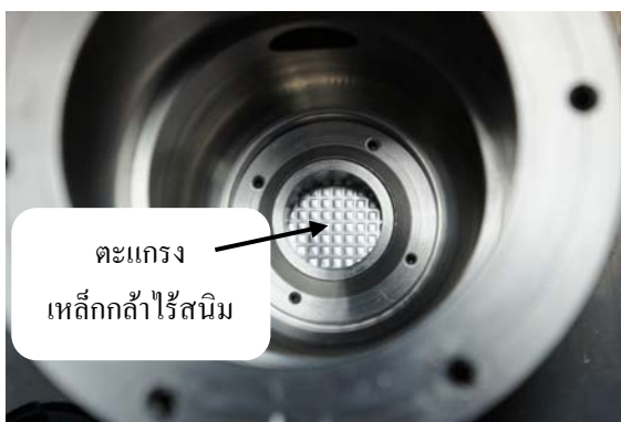
ภาพที่ 3.30 อะลูมิเนียมฟอยล์ประกบกับตะแกรงเหล็กกล้าไร้สนิมและประกอบใส่ห้องสุญญากาศ
