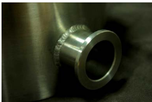
ภาพที่ 3.16 ท่อช่องสูบลู่วสุญญากาศของห้องสุญญากาศขนาดเป็นมาตรฐาน DN KF25
