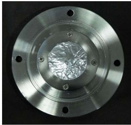
ภาพที่ 3.21 แผ่นฟอยล์ที่ถูกขึงตึง
