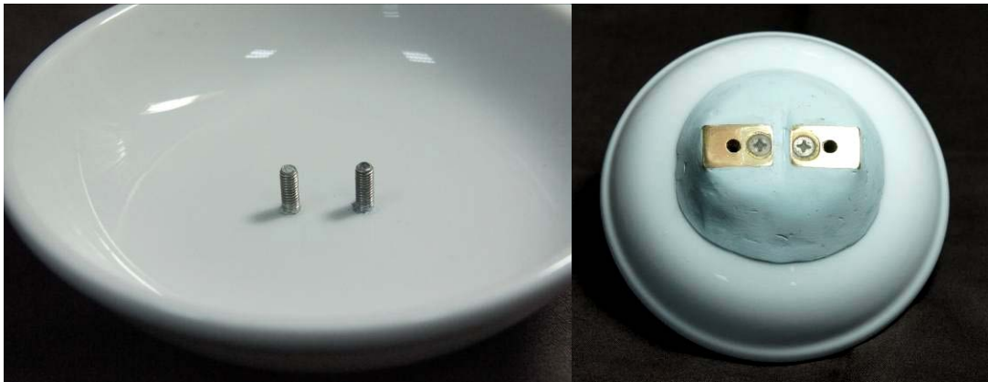
ภาพที่ 3.4 การยึดขั้วทองเหลืองซึ่งเป็นขั้วต่อไฟฟ้าจากภายนอกเข้าสู่ใต้หลอดและท่อไฟกั๊ส
