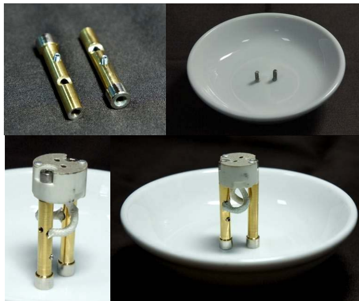
ภาพที่ 3.6 การจับยึดขั้วหลอดไฟฟ้ากับถ้วยเซรามิกและเชื่อมสายไฟฟ้ากับเสาขั้วไฟฟ้า
