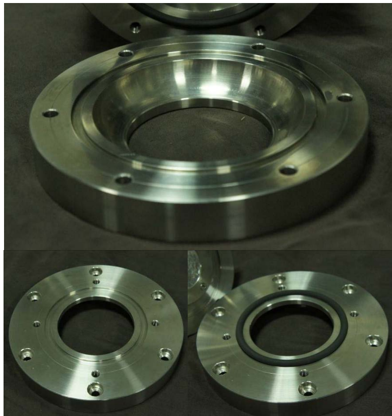
ภาพที่ 3.19 ชิ้นส่วนแป้นฝาล่างที่สร้างขึ้น
