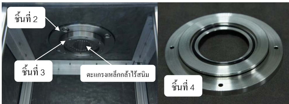
ภาพที่ 3.24 ชั้นส่วนฐานซึ่งแผ่นพอยล์หน้าต่างชุดล่างที่สร้างขึ้น
