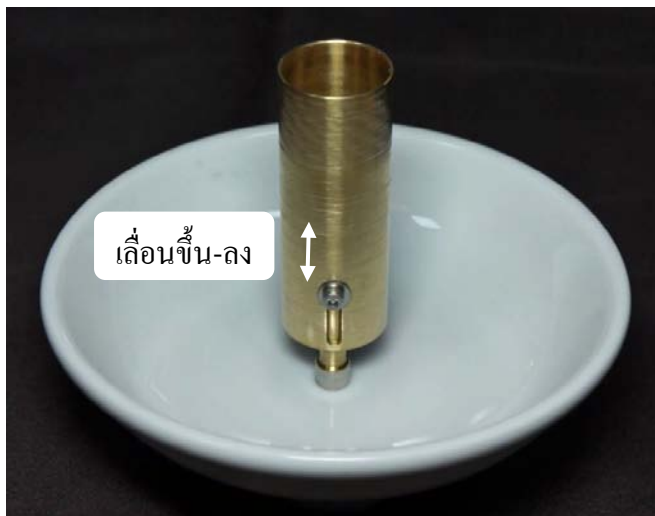
ภาพที่ 3.8 การปรับระดับของท่อไฟกล่าอิเล็คตรอน
