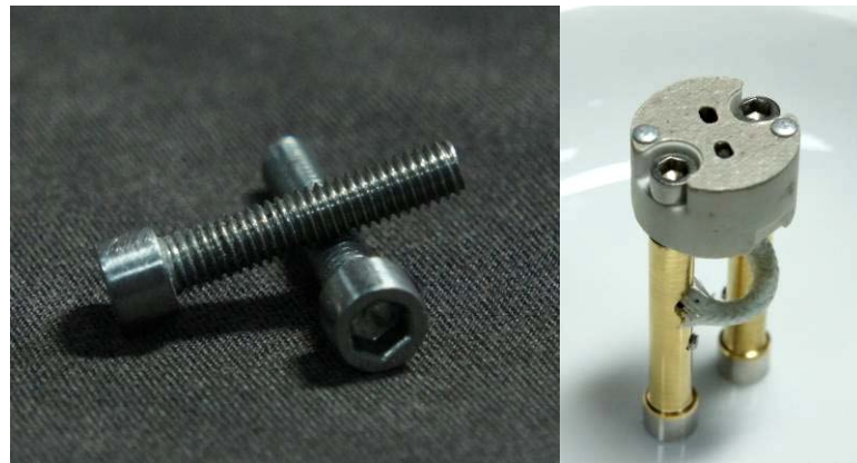
ภาพที่ 3.5 สลักเกลียวสำหรับยึดขั้วหลอดไฟฟ้ากับเสาขั้วไฟฟ้าทองเหลืองที่ดัดองกลึงเฉพาะ
