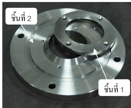
ภาพที่ 3.22 วงแหวนฐานซึ่งแผ่นฟอยล์หน้าต่างชุดบนที่สร้างขึ้น
