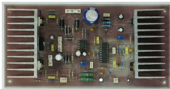
ภาพที่ 3.35 วงจรแหล่งจ่ายไฟฟ้าสัปดาห์ต่ำสำหรับส่วนกำเนิดลำอิเล็กตรอน
