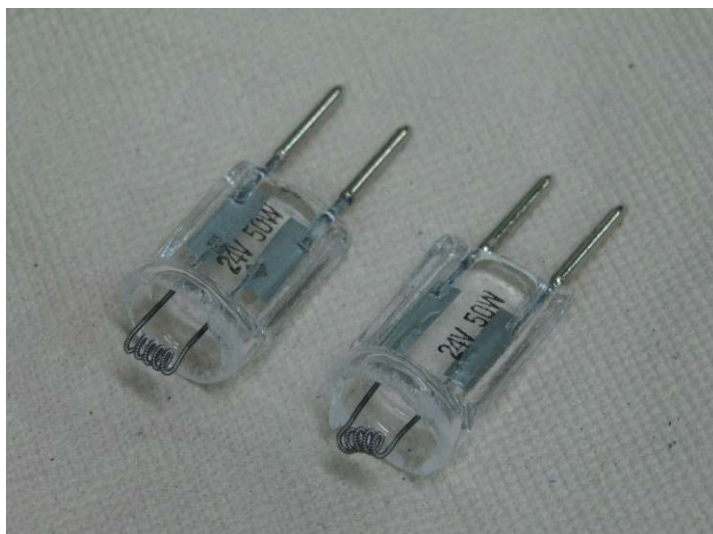
ภาพที่ 3.3 หลอดทังสเตนฮาโลเจนที่ตัดส่วนหลอดแก้วออก
