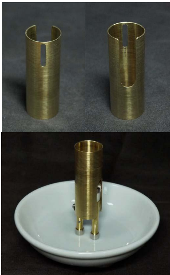
ภาพที่ 3.7 ท่อโฟกัสลำอิเล็กตรอนและการยึดกับขั้วไส้หลอด
