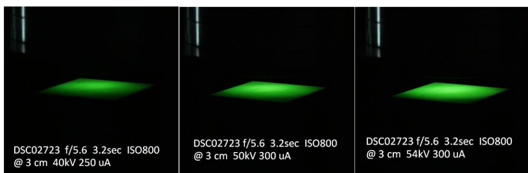
ภาพที่ 4.6 ภาพถ่ายแสงเรืองที่เกิดขึ้นบนฉากเรืองแสง
