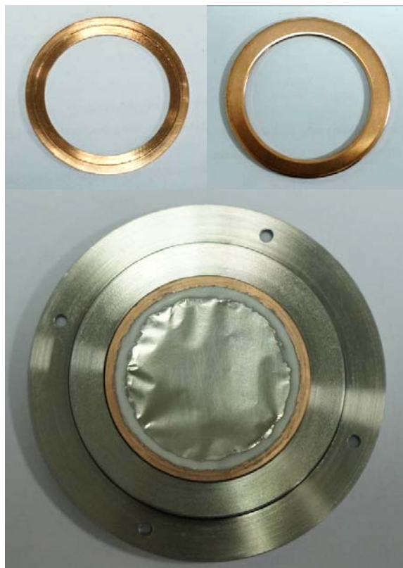
ภาพที่ 3.29 ฟอยล์อะลูมิเนียมซึ่งบนวงแหวนทองแดงและนำไปวางในชุดฐานยึดขึ้นล่าง
