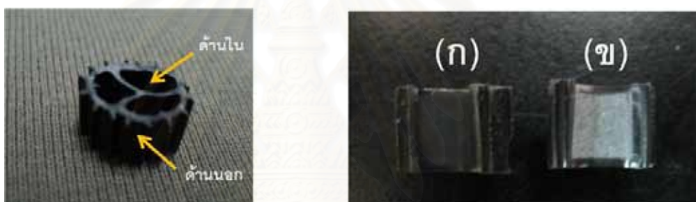
ภาพที่ 4.6 ลักษณะพื้นผิวตัวกลาง BCN 009 ภายหลังจากเลี้ยงเชื้อเป็นเวลา 3 เดือน (ก) ตัวกลางที่ไม่มีตะกอนเกาะ (ข) ตัวกลางภายหลังจากการเลี้ยงเชื้อ
