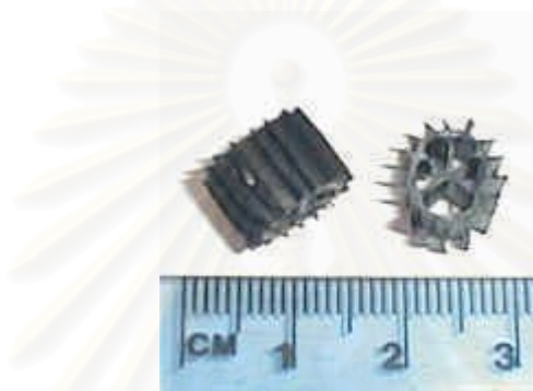
รูปที่ 2.5 ตัวกรองชีวภาพชนิด Bead Filter ชื่อทางการค้าคือ BCN-009 (ที่มา: http://www.piscesengineering.co.uk/filter_media.htm )
