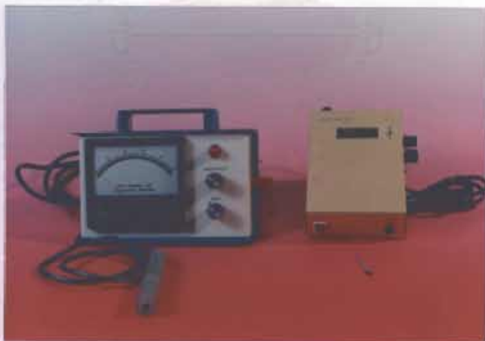
รูปที่ 3.11 รูปแสดงการเปรียบเทียบเครื่องวัดน้ำตาลกลูโคสที่ขายโดยบริษัท Yellow Springs instrument (ซ้ายมือ) กับ เครื่องวัดน้ำตาลกลูโคสที่ทำขึ้น (ขวามือ)
