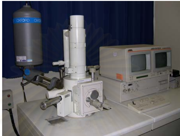
ภาพที่ 9 แสดง Scanning Electron Microscope (JSM 5410LV, JEOL, Ltd , Tokyo, Japan)
