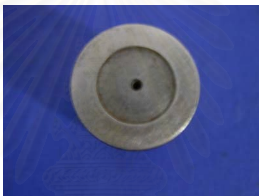
รูปที่ 4 แบบที่กลิ้งที่มีความลึกของแบบเท่ากับความหนาที่ต้องการ
