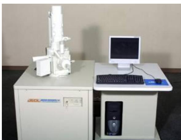
รูปที่ 3.5 เครื่องจุลทรรศน์อิเล็กตรอนแบบส่องกราด (SEM) รุ่น JEOL JSM 6060
