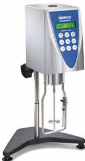
รูปที่ 3.7 เครื่องวัดความหนืดยี่ห้อ Brookfield Programmable DV II (USA)
