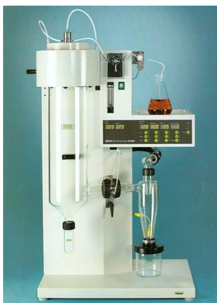
รูปที่ 3.2 แสดงเครื่องอบแห้งแบบพ่นฝอยรุ่น Buchi B 290
